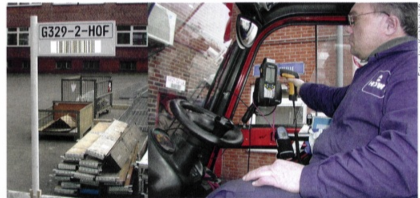
Im Freigelände gelagerte Waren sind mit Barcode-Pylonen versehen, die z.B. vom Gabelstapler aus bequem erfasst werden können. Das Mobilgerät übermittelt die Daten in die Warenwirtschaft.
